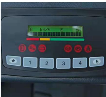
Controlador ZAPI com painel de instrumentos multifuncionais
